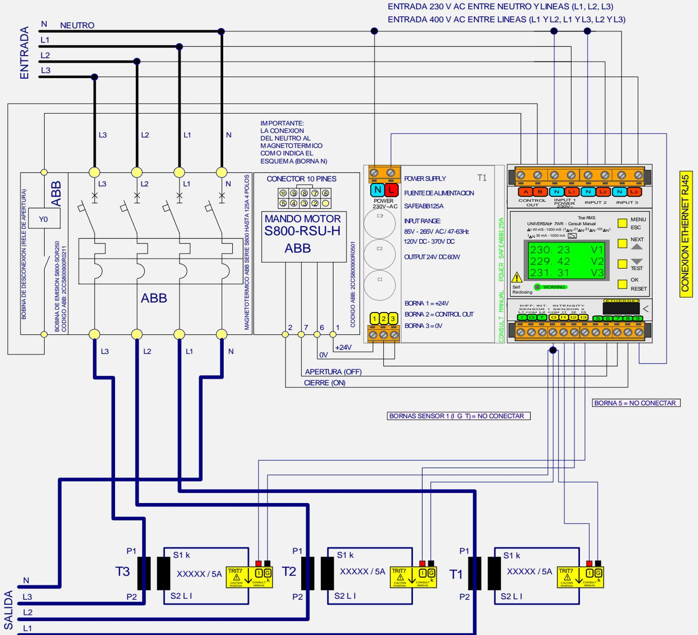
T1, T2 Y T3 TRANSFORMADOR TOROIDAL DE INTENSIDAD DE LINEA PROGRAMAR LA RELACION DE INTENSIDAD DEL TRANSFORMADOR XXXXX / 5A EN LA UNIDAD UNIVERSAL+ 7WR
