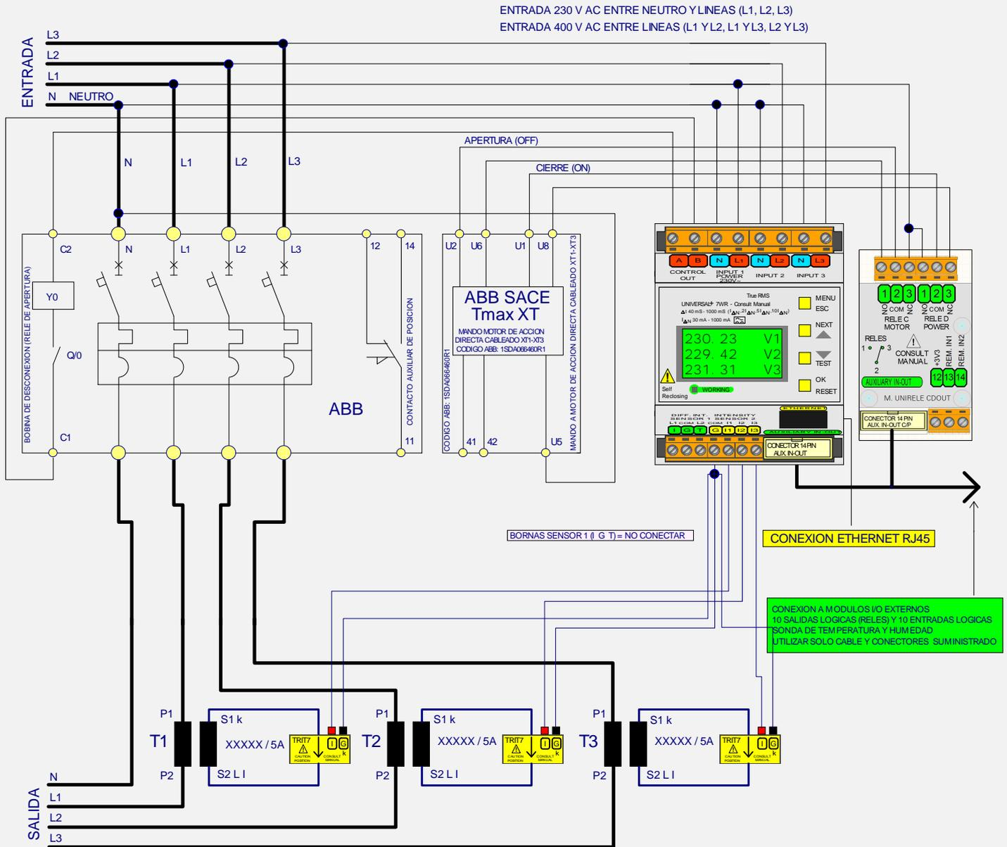
T1, T2 Y T3 TRANSFORMADOR TOROIDAL DE INTENSIDAD DE LINEA PROGRAMAR LA RELACION DE INTENSIDAD DEL TRANSFORMADOR XXXXX / 5A EN LA UNIDAD UNIVERSAL+ 7WR
